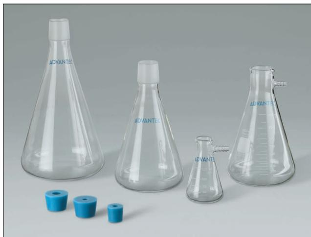
Matraces y tapones compatibles con los soportes de filtro Advantec
